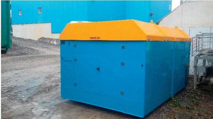
Construction solide à double paroi en tôle d'acier S-355 de 5 mm
