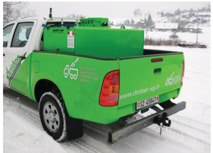
Beim Transport von Kraftstoff bis 450 Liter im innovativen Betankungssystem der Bako AG profitiert der Unternehmer von den Freistellungen gemäss ADR 1.1.3.1c. Fotos: Bako
