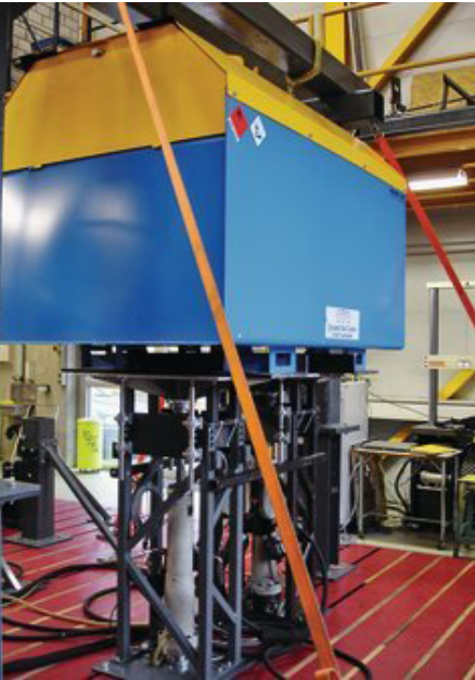
An IBC-Baustellentanks werden harte Anforderungen gestellt: Hier der IBC-Tank der Bako AG bei der Vibrationsprüfung im DTC Dynamic Test Center AG.
