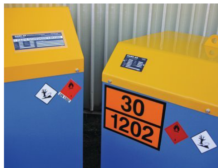
Kleiner Unterschied, grosse Wirkung: Dank internationaler ADR-Zulassung darf der Bako-Baustellentank (links), neben anderen Vorteilen, auch durch Tunnels wie Gotthard, Via Mala und Alvaschein transportiert werden.
