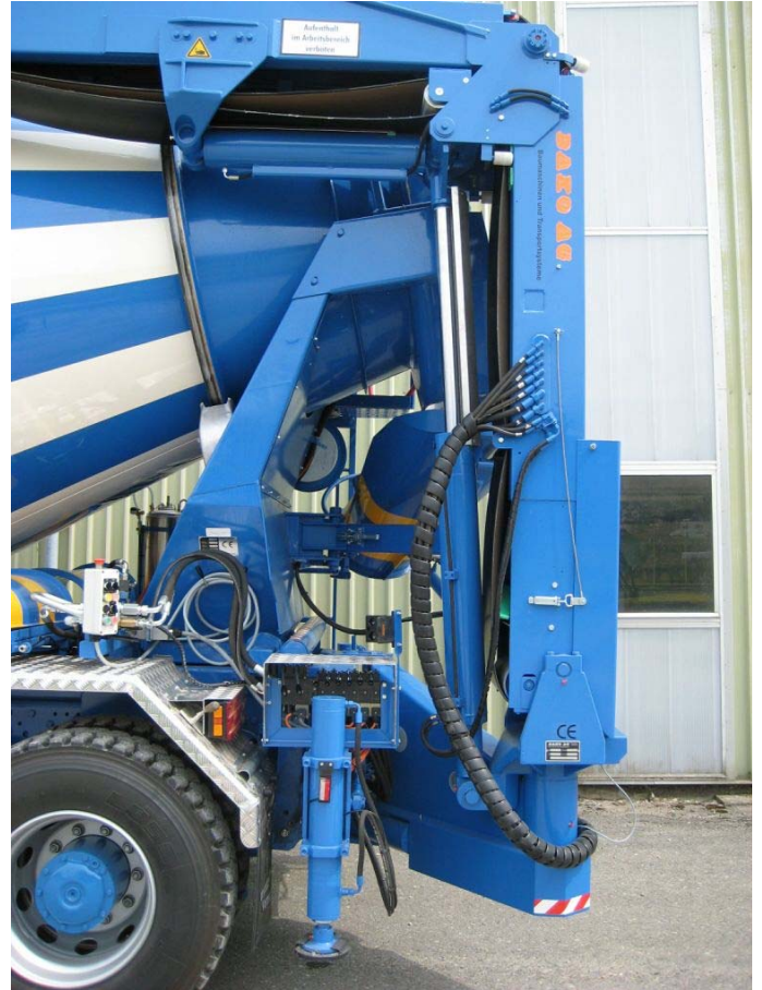
Ein kurzer hinterer Überhang sorgt für gute Manövrierbarkeit auf engen Baustellen und eine gute Gewichtverteilung.
