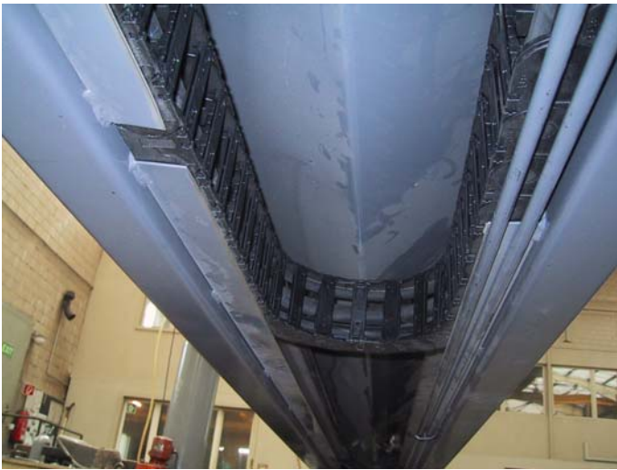
Mastprofil in „SIPS“ - Ausführung (Side Impact Protection System). Idealer Schutz für Leitungen vor Beschädigung und Verschmutzung.
