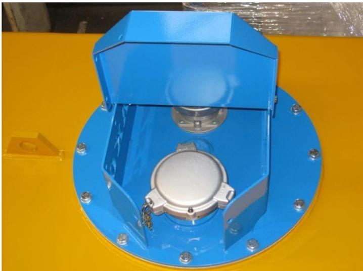
Das BAKO Domdeckelsystem ist gut geschützt gegen Beschädigungen und das Eindringen von Wasser und Schmutz. Optional kann es noch mit einem Vandalenschutz ausgerüstet werden
