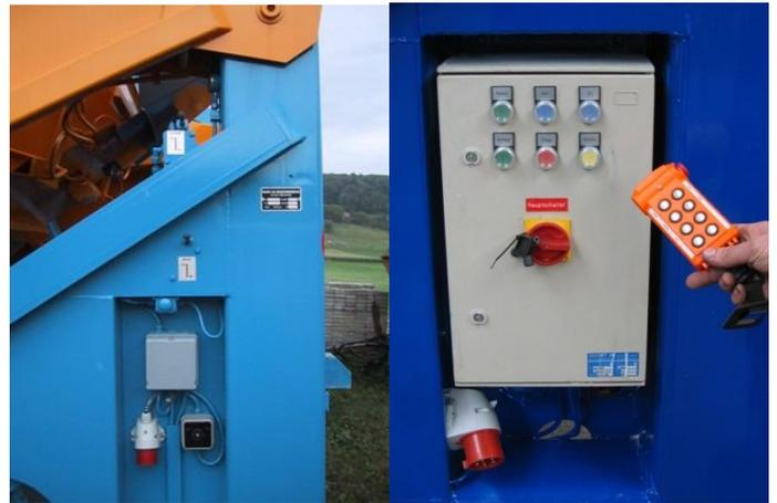
Manuelle Betätigung (links) oder Steuerkasten mit Anschlussmöglichkeit einer Funkfernsteuerung (rechts), geschützt durch Rahmenkonstruktion
