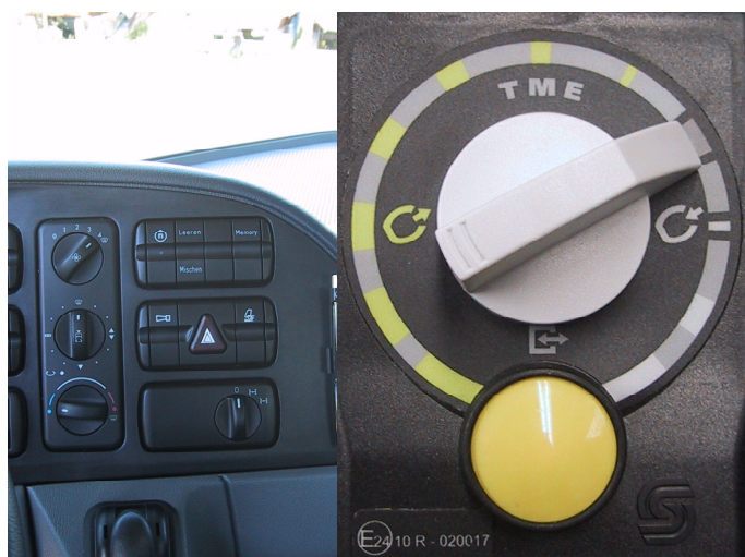
Kabinensteuerung durch Fz-Originalschalter oder mit TME Steuereinheit.
